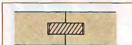
Рис. 1. Между вставной рейкой и основанием пазов должен быть небольшой зазор.
